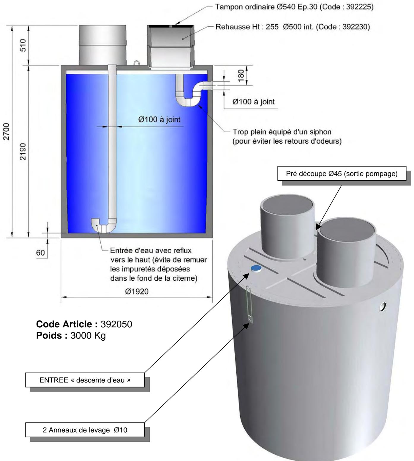
Cet appareil a été conçu pour une utilisation exclusive en sol écartant tout passage de véhicule et pour le stockage d'eaux pluviales ou de source de qualité non alimentaire.
